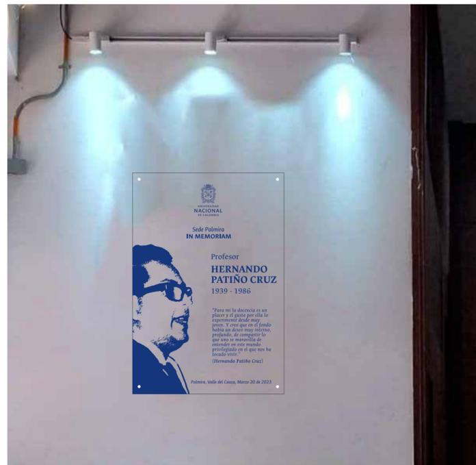
Placa en acrílico transparente de 5 mm de espesor, anclada con dilatadores en acero inoxidable, aplicación de vinilo adhesivo espejo sobre acrílico.
